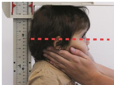
4. Relevez la hauteur au millimètre près jusqu'à la flèche rouge pointant vers l'échelle métrique. La deuxième flèche rouge pointant à l'échelle impériale peut servir pour le système métrique.
