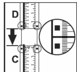
3. Schieben Sie eine der beiden Abstützungen auf die Messlatte, dann die Kopfauflage zum Messen und dann darüber den zweiten Abstandhalter. Setzen Sie die Abstandhalter so an, dass sie nicht auf den Verbindungsstellen der Messlattenabschnitte sitzen.
