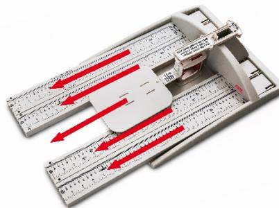
2. Stecken Sie die Messslatten fest ineinander und vergewissern Sie sich, dass der unterste Abschnitt (mit Pfeil markiert) fest im Schlitz in der Grundplatte einsteckt und dass die Symbole ■, ● und ☆ korrekt aufeinander ausgerichtet sind.
