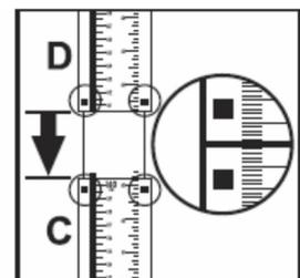
3. Far scorrere uno dei due stabilizzatori sul montante, seguito dal poggiatesta di misurazione e infine far scorrere su di esso il secondo stabilizzatore. Posizionare gli stabilizzatori in modo che essi rimangano lontani dai giunti sulle sezioni dei montanti.
