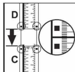
3. Faites glisser l'une des deux stabilisateurs dans le mât, puis le curseur et faites glisser le second stabilisateur au-dessus. Placez les stabilisateurs de manière qu'ils soient séparés des joints sur les sections verticales.
