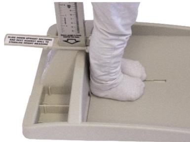
2. Vergewissern Sie sich, dass die Knie durchgedrückt sind und dass Po und Schulterblätter die Messlatte berühren. Die Schultern können gelockert sein und die Arme seitlich am Körper anliegen.
