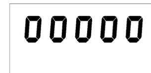
2. Die Waage liegt unter ihrem Nullbereich. Kontrollieren Sie, dass sich nichts unter der Waage verklemmt hat und schalten Sie sie aus und wieder ein. Wenn die Waage weiterhin die Fehlermeldung anzeigt, dann weist dies auf einen Fehler der Waagenelektronik hin.
