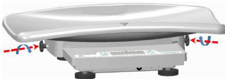
**Installieren Sie die Wiegeschale an der richtigen Stelle und ziehen Sie die Schrauben auf beiden Seiten fest.**
