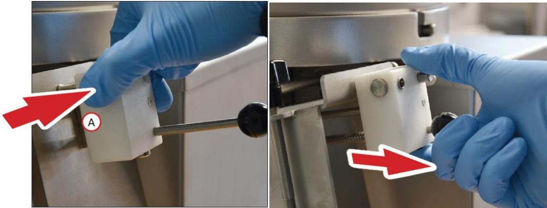
2. Spannen Sie die Druckfeder. Stecken Sie den Papierblock auf die Haltestange und entfernen Sie danach die Banderolen und die Deckpappe.
