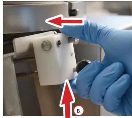
4. Lösen Sie die Arretierung des Papierhalters, in dem Sie den Hebel (C) nach oben ziehen und danach den gesamten Papiereinleger gegen die Trommel drücken.
