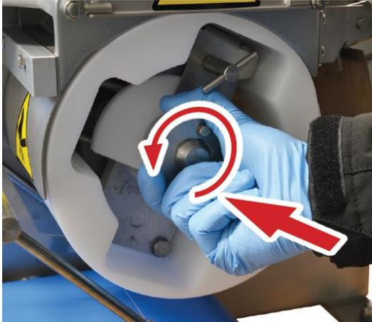
Die Trommel ist richtig montiert, wenn der Trommelring in den Schlitz am Ende der Antriebswelle einrastet.
