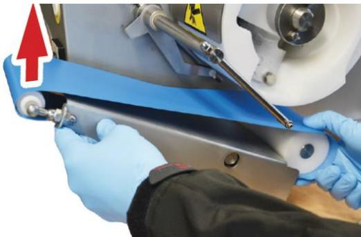
Ziehen Sie das Förderband mit dem Gleitblech von der Maschine ab.
