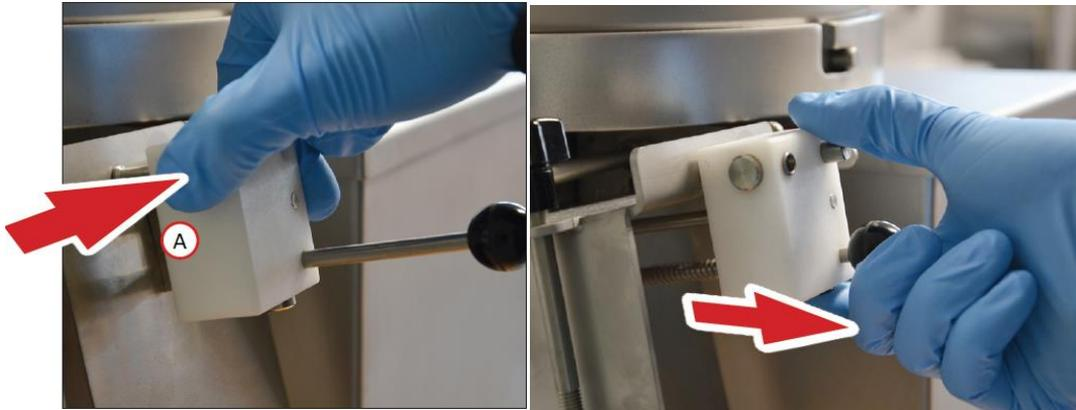
2. Spannen Sie die Druckfeder. Stecken Sie den Papierblock auf die Haltestange und entfernen Sie danach die Bänderolen und die Deckpappe.
