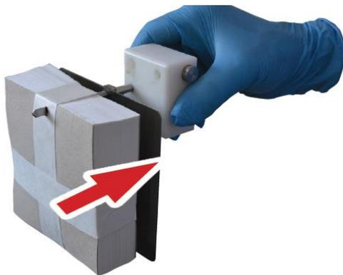
3. Stecken Sie den Papierhalter in die Führung, bis er hörbar einrastet. Drücken Sie den Knopf (B). Die Feder drückt den Papierstapel nach vorn.
