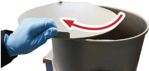
Drehen Sie den Trichter entgegen dem Uhrzeigersinn und heben Sie ihn ab.
