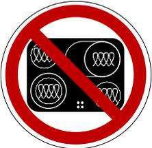
Versuchen Sie niemals, die Waage mit / auf einem Induktionskochfeld/-herd zu laden. Dies ist technisch NICHT möglich und kann zudem zur Zerstörung der Waage führen.
