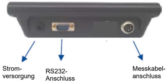
Die RS232C-Schnittstelle dient zum Anschluss eines Druckers, PC oder einer Zweitanzeige.
