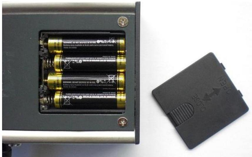
Zum Öffnen des Batteriefachs schieben Sie den Hebel in Richtung „OPEN“, zum Verriegeln in Richtung „Close“. 4 x AAA 1,5V Alkaline Batterien.
